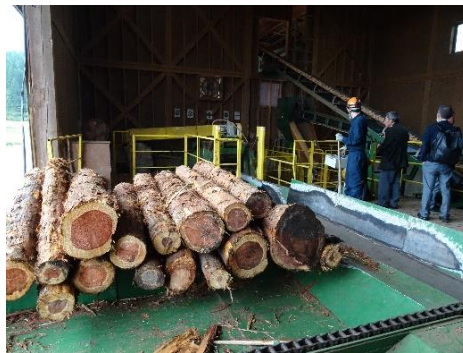
原木を切削機に投入する様子
